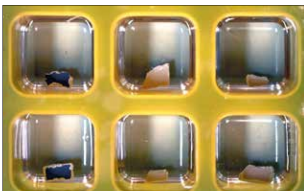
Obr. 10. Ukázka formy se vzorky připravenými k zalití pryskyřicí za sníženého tlaku. Postup využívá předem připravené podložky zhotovené ze zalévací pryskyřice. V tomto případě jsou modelové vzorky orientovány lícem nahoru.
