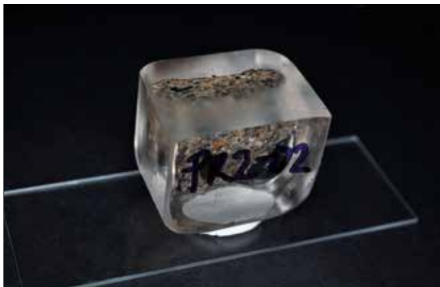
Obr. 12. Vybroušený a vyleštěný nábrus vzorku z obr. 8 připravený pro optickou mikroskopii. Fixaci vzorku na plastelině lze zajistit, aby rovina řezu byla při pozorování kolmo na optickou osu mikroskopu.
